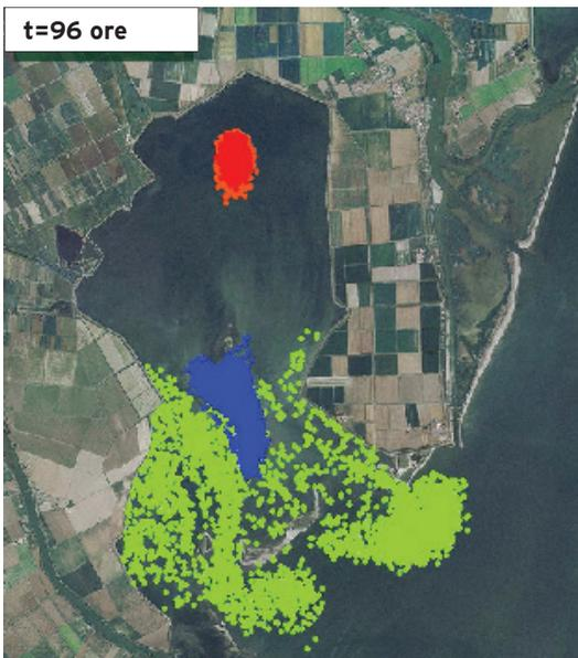
**Figura 87:** situazione attuale. Simulazione del trasporto di particelle con il modello lagrangiano per la marea sinusoidale semidiurna oscillante tra  $\pm 0.5$  m s.l.m. (particelle in verde e arancio per lo strato 10 e in rosso e blu per lo strato 7).
