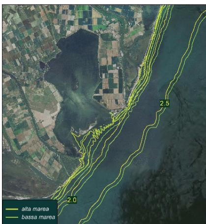
**Figura 40:** mappa delle altezze d'onda nel caso di una mareggiata di Scirocco con onda al largo della durata di 1 g/anno in condizioni di alta e bassa marea ( $H_s=2.89$  m;  $T=7.53$  s;  $Dir=145^\circ$ ). La rappresentazione ha un passo per le altezze d'onda di 0.5 m.
