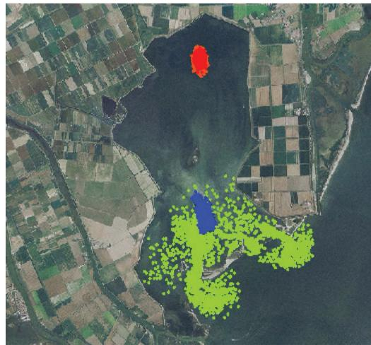
**Figura 86:** situazione attuale. Simulazione del trasporto di particelle con il modello lagrangiano per la marea sinusoidale semidiurna oscillante tra  $\pm 0.5$  m s.l.m.: confronto tra 20 (sopra) e 30 (sotto: particelle in verde e arancio per lo strato 10 e in rosso e blu per lo strato 7).
