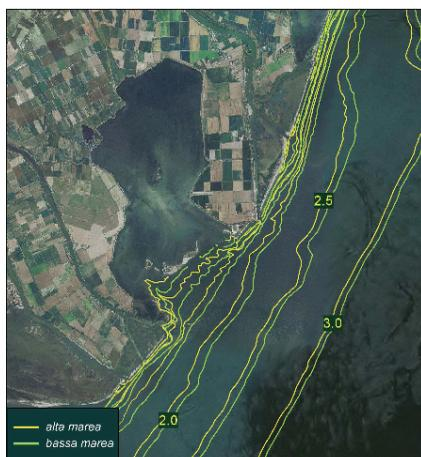
**Figura 39:** mappa delle altezze d'onda nel caso di una mareggiata di Bora con onda al largo della durata di 1 g/anno in condizioni di alta e bassa marea ( $H_s=3.46$  m;  $T=7.05$  s;  $Dir=60^\circ$ ). La rappresentazione ha un passo per le altezze d'onda di 0.5 m.
