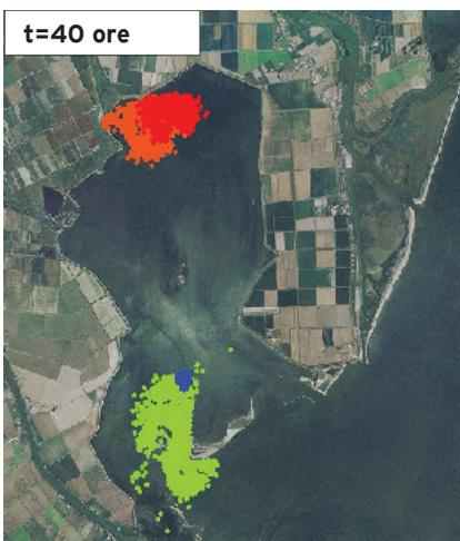
**Figura 88:** situazione attuale. Simulazione del trasporto di particelle con il modello lagrangiano per la marea sinusoidale semidiurna oscillante tra  $\pm 0.5$  m s.l.m. e un vento di Bora che spira per 12 ore ogni 24 ore alla velocità di 4 m/s. (particelle in verde e arancio per lo strato 10 e in rosso e blu per lo strato 7).
