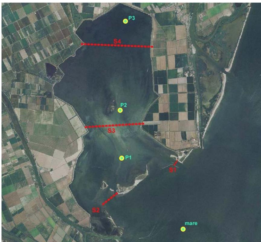
**Figura 12:** ubicazione dei punti e delle sezioni di riferimento per la rappresentazione grafica dei risultati delle simulazioni.
