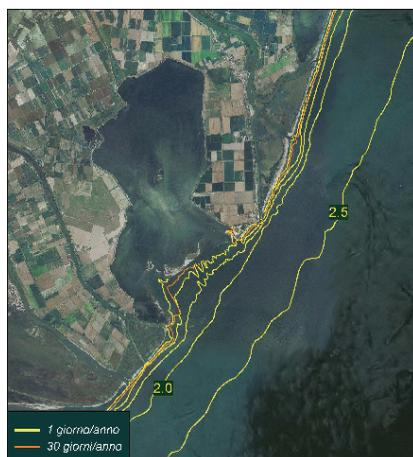
**Figura 45:** mappa delle altezze d'onda nel caso di una mareggiata di Scirocco con onda al largo della durata di 1 g/anno e 30 qg/anno in condizioni di livello medio del mare.
