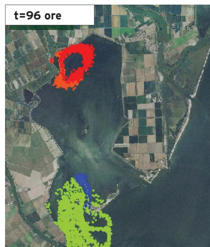
**Figura 89:** situazione attuale. Simulazione del trasporto di particelle con il modello lagrangiano per la marea sinusoidale semidiurna oscillante tra  $\pm 0.5$  m s.l.m. e un vento di Bora che spira per 12 ore ogni 24 ore alla velocità di 4 m/s. (particelle in verde e arancio per lo strato 10 e in rosso e blu per lo strato 7).
