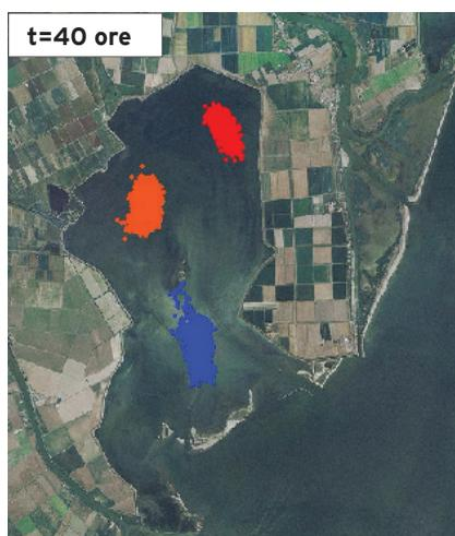
**Figura 91: situazione attuale. Simulazione del trasporto di particelle con il modello lagrangiano per la marea sinusoidale semidiurna oscillante tra  $\pm 0.5$  m s.l.m. e un vento di Bora che spira per 12 ore ogni 24 ore alla velocità di 10 m/s. (particelle in verde e arancio per lo strato 10 e in rosso e blu per lo strato 7).**
