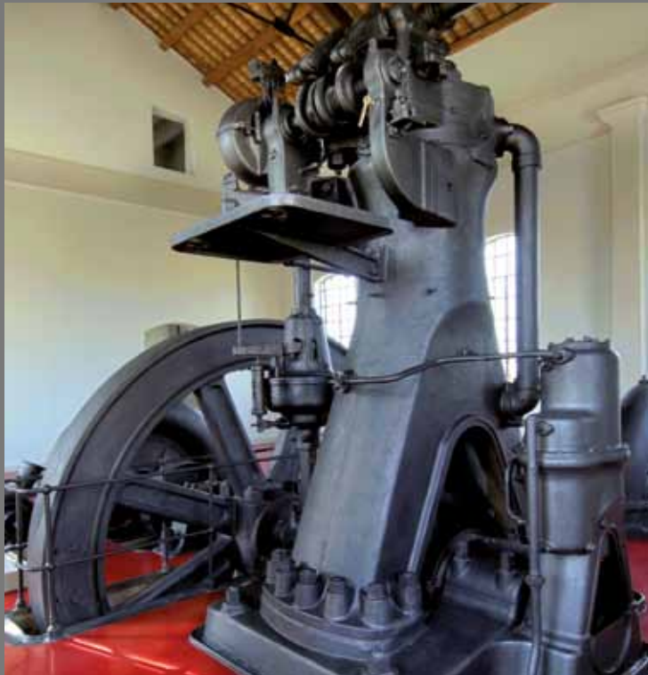
TAVOLA 4c. Ex Idrovora Chiavichetta Motore Desel e volano, un tempo utilizzati per il funzionamento della pompa centrifuga
